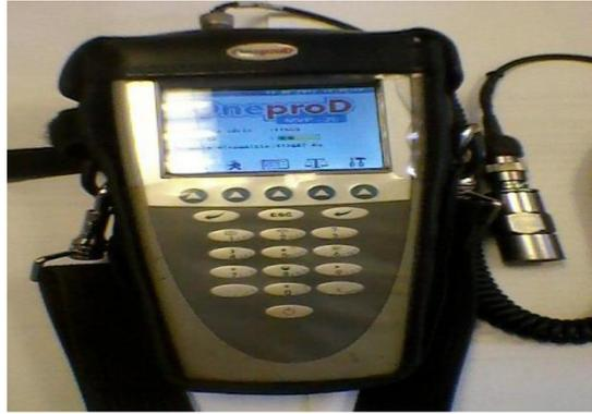
Fig.V.2 : Analyseur MVP-200
