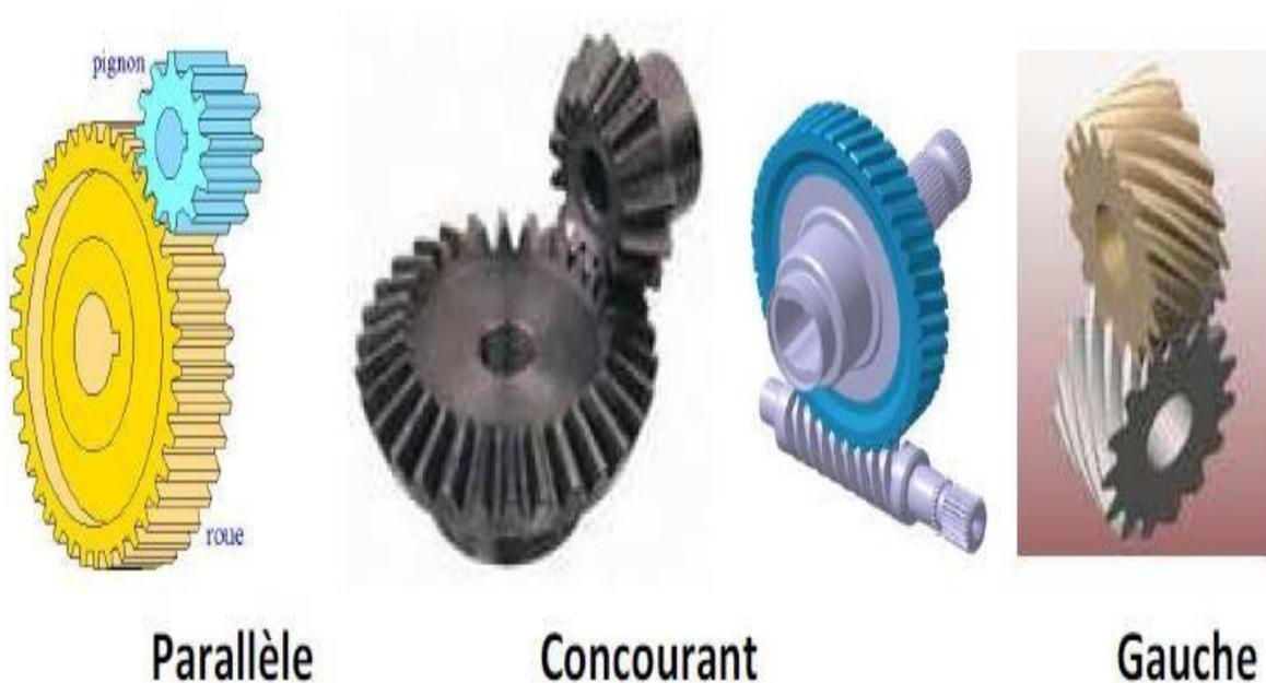
**Fig.IV.27** : Différents types d'engrenage. [13]
