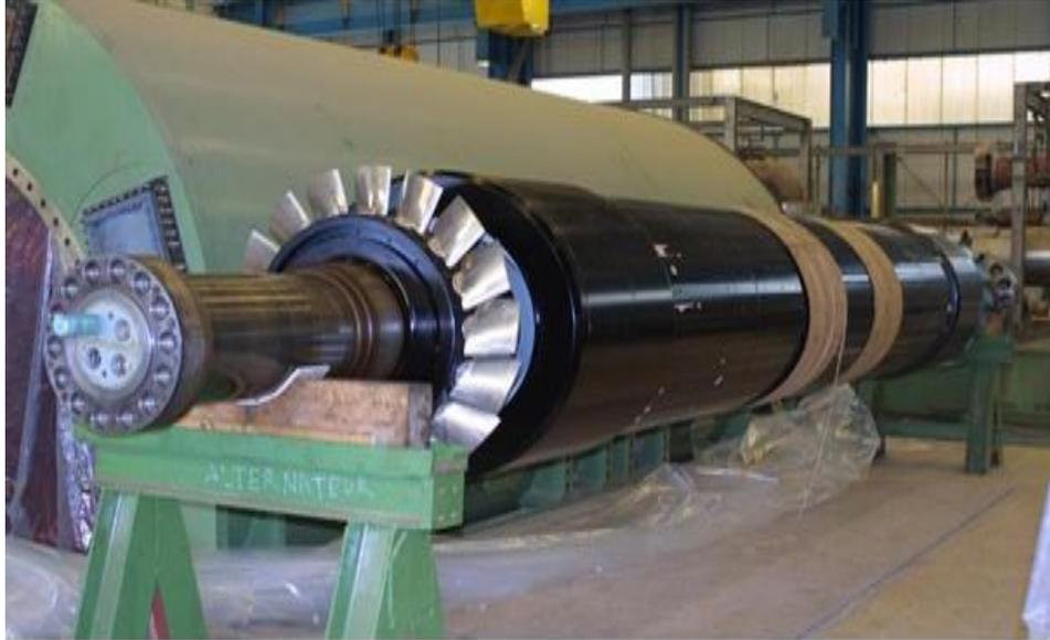
**Fig.I.10:** Photo de partie mobile de la machine (Le rotor)
