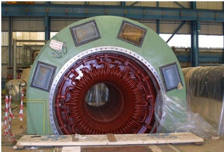
**Fig.I.9** : Photo de partie fixe de l'alternateur (Le stator)
