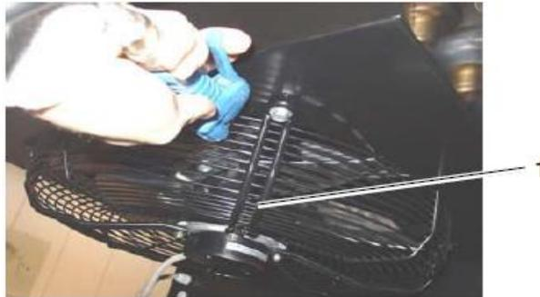
**Figure V.5:** Procédure de Nettoyage du radiateur
