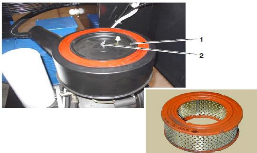
**Figure V.2:** Changement filtre à air
