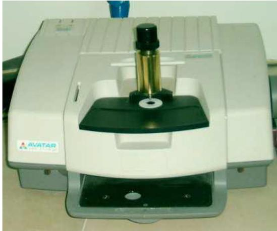
**Figure III.7** : spectroscopie infrarouge à transformé de Fourier (FTIR).
