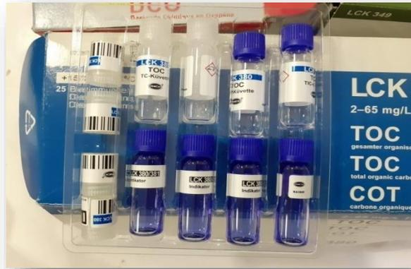
**Figure III.6 :** Les réactifs LCK 380/381
