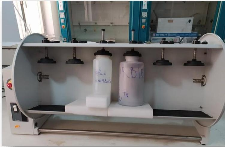
**Figure A.2 :** Dispositif d'agitation pour l'essai de lixiviation
