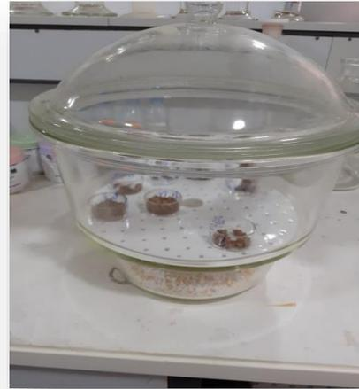
*Figure A.3* : Autre appareillage utilisé : étuve et dessiccateur
